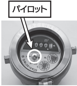
メーターボックス内の水道メーター
